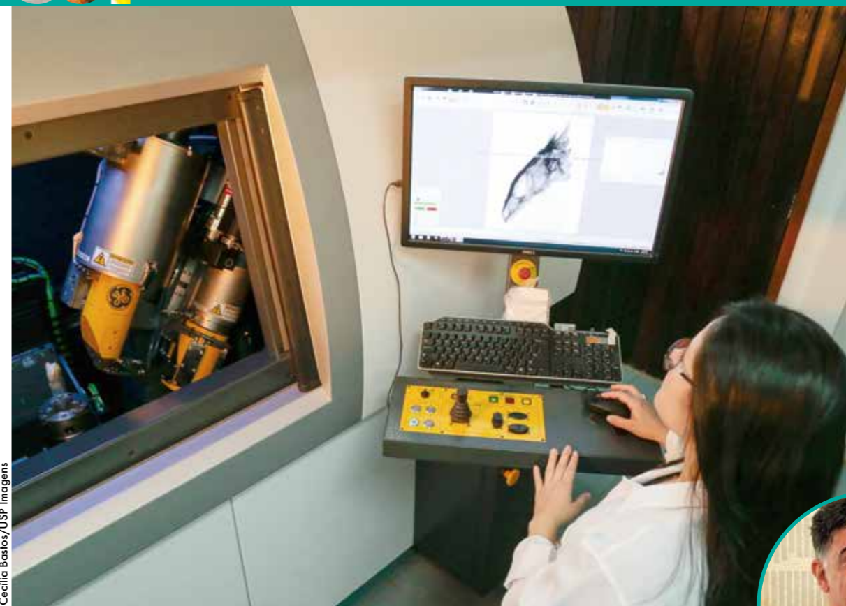
O uso do tomógrafo permite que análises anatômicas sejam realizadas sem danificar os exemplares
