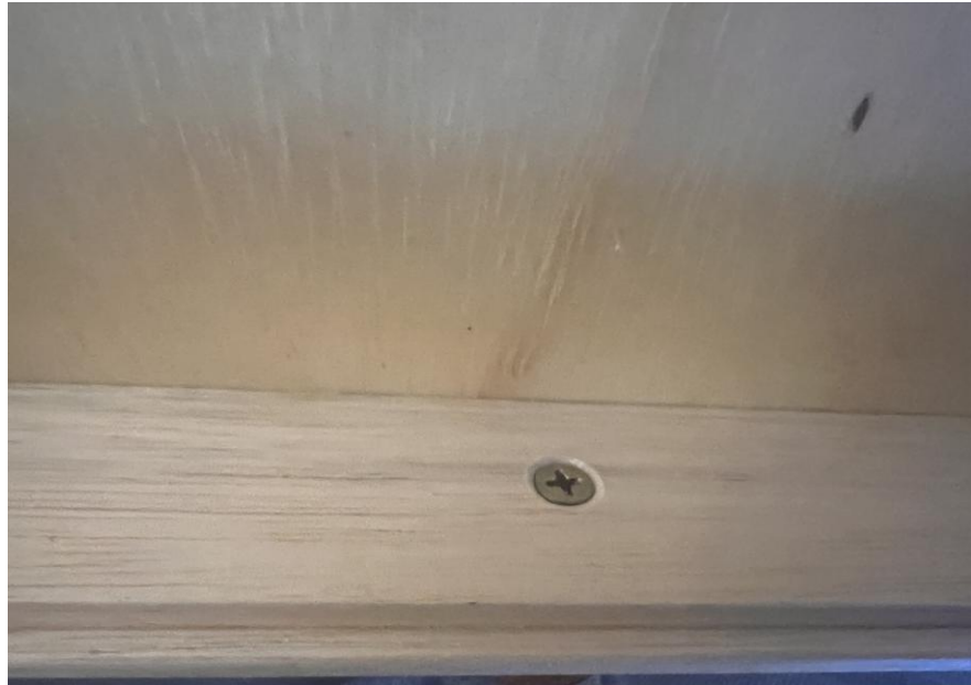
4.1.8.6. Item 01 – Gaveta entomológica – detalhe do puxador (fixação interna)
